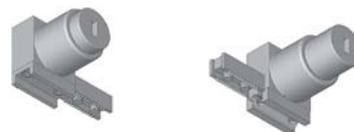
Замок 8620/8000-S может быть как правым, так и левым. Для изменения положения нужно отвернуть винты и развернуть нижнюю часть замка.
