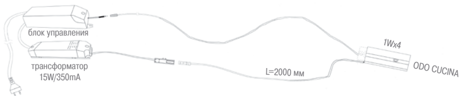
Подключение трансформатора к светильнику через разъем провода MicroFast 8 мм
