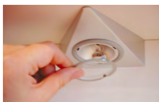
3. Возьмите защищенными руками (в перчатках) новую лампу, поднесите штырями цоколя к патрону и установите ее в патрон.
