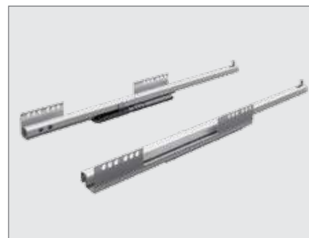
Направляющие Quadro 25 с демпфером Silent System Частичное выдвижение, нагрузочная способность 25 кг 554 - 555
