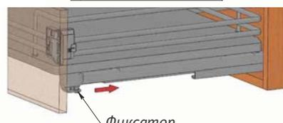
Фиксатор Быстрый монтаж (Clip-on)
